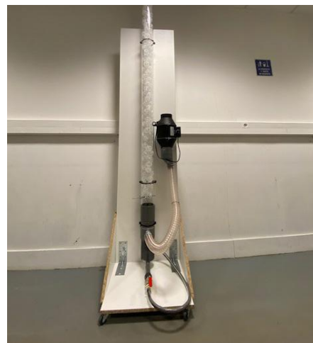
Colonne de stripping de laboratoire
