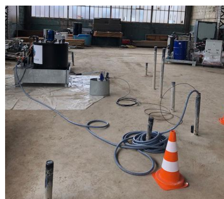
Essai pilote sur site d'injection d'oxydant
