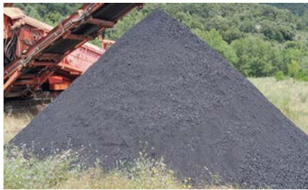
Illustration n°4 : fraction fine issue du criblage
