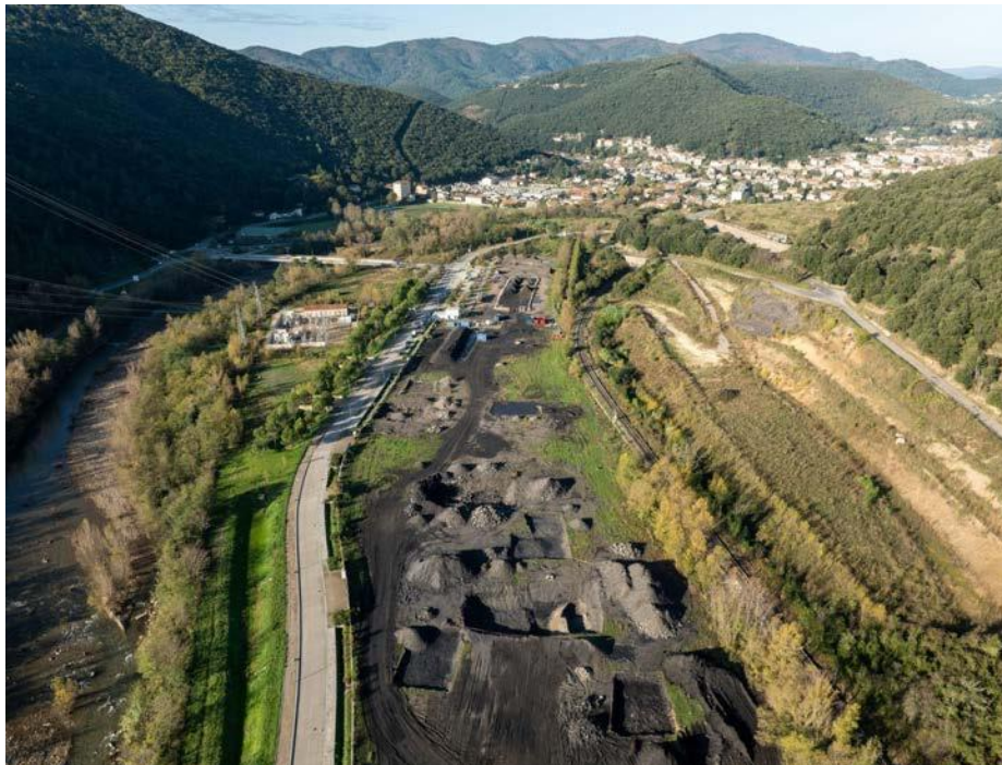
Illustration n°5 : Vue drone du chantier de traitement de la pollution - phase de gestion des PPC
