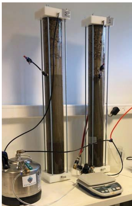
Essais de percolation multicouches
