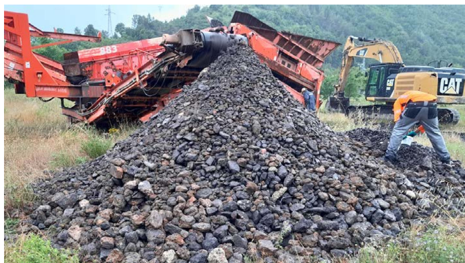
Illustration n°3 : fraction intermédiaire issue du criblage
